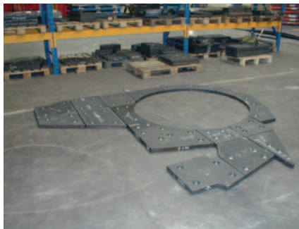
↑ Bekledingsplaten voor versnipperaars in de metaalrecycling
