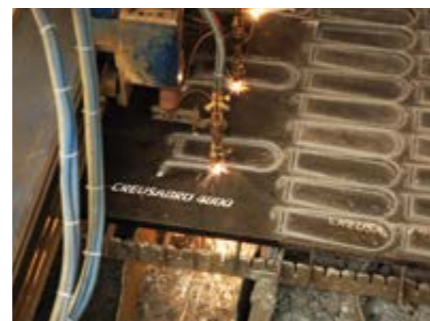
↑ Oxicorte de martillos de un molino
