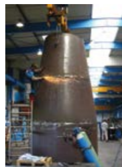
↑ Realizacion de un cono para stock de aglomerado
