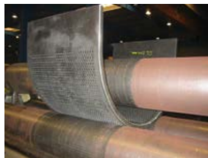
↑ Calandratura di un settore forato
