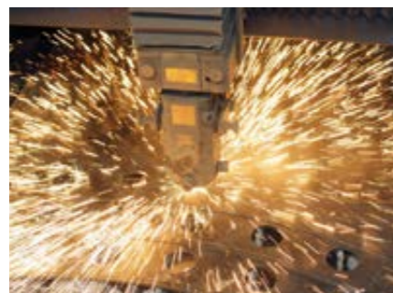
↑ Chapa perforada cortada por laser
