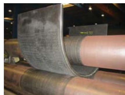
↑ Calandratura di un settore forato
