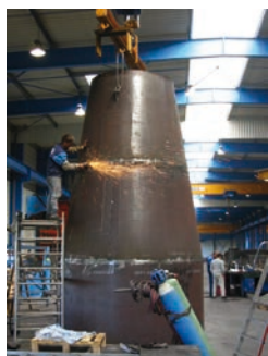
↑ Réalisation d'un cône de stockage d'agrégats
