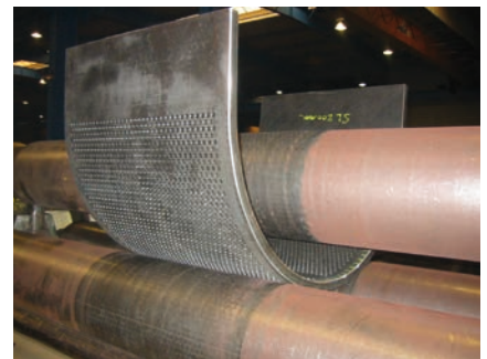
↑ Cintrage d'un secteur de tonneau de criblage
